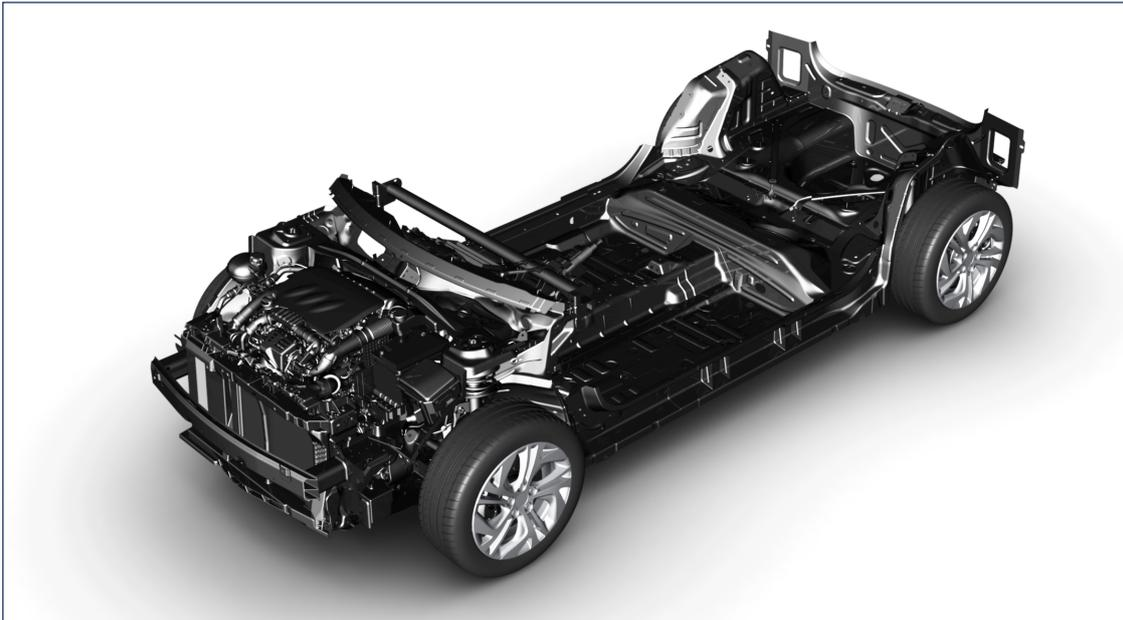
CMP (Common Modular Platform)はグループPSAをカバーする、まったく新しいモジュラー構造のマルチエネルギー対応プラットフォームです。
